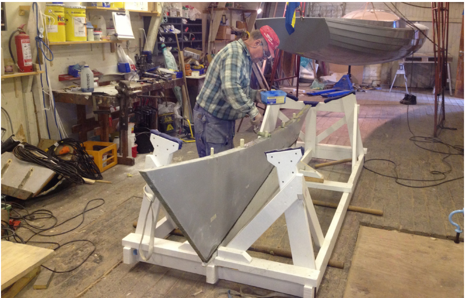
Ragge under arbetet med att montera kölen på nr 533
